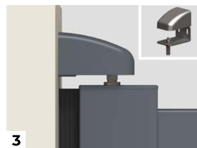
3 Gond haut en acier laqué avec cache gond en aluminium laqué à la couleur du portail. Axe diam 12 en inox. Système anti soulèvement.
